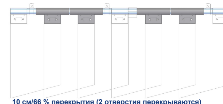
10 см/66 % перекрытия (2 отверстия перекрываются)
