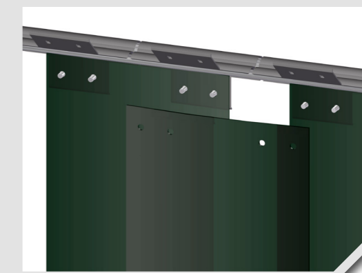
5 см/33 % перекрытия (1 отверстие перекрывается)
